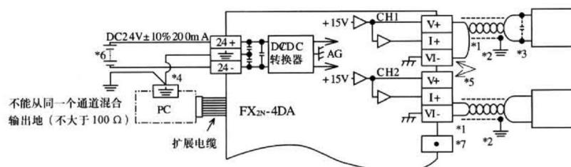
\*1 对于模拟输出使用双绞屏蔽电缆。电缆应远离电源线或其它可能产生电气干扰的电线。
